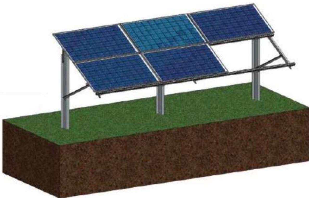
Слика 12. Приказ на монтажната конструкција
